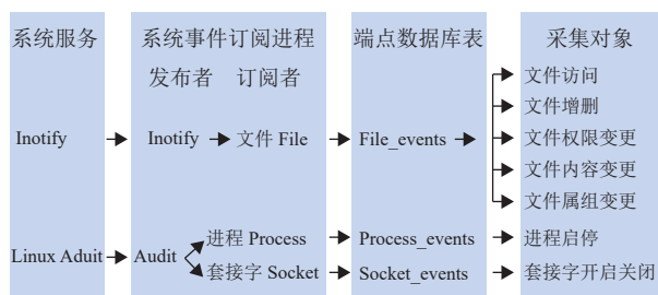
图5 系统服务、发布者、订阅者、端点数据库表和采集对象的对应关系
