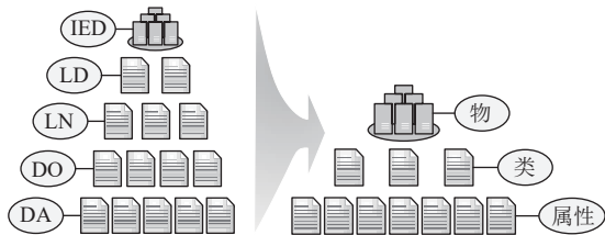
图 2 面向物联网的配电终端信息模型的层次结构 Fig. 2 Hierarchical structure of distribution terminals information model for IoT
