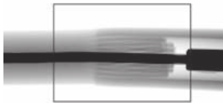
图 6 导线压接不到位的 X 射线照片 Fig. 6 X-ray photo of the wire crimp not in place
